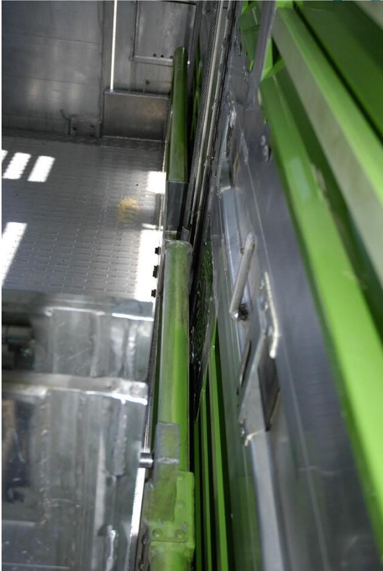
Zwischen Hubböden und Fahrzeugwand besteht die Gefahr des Einklemmens von Gliedmaßen. Hohe Ränder an den Hubböden, wie hier, sind ein guter Schutz.
