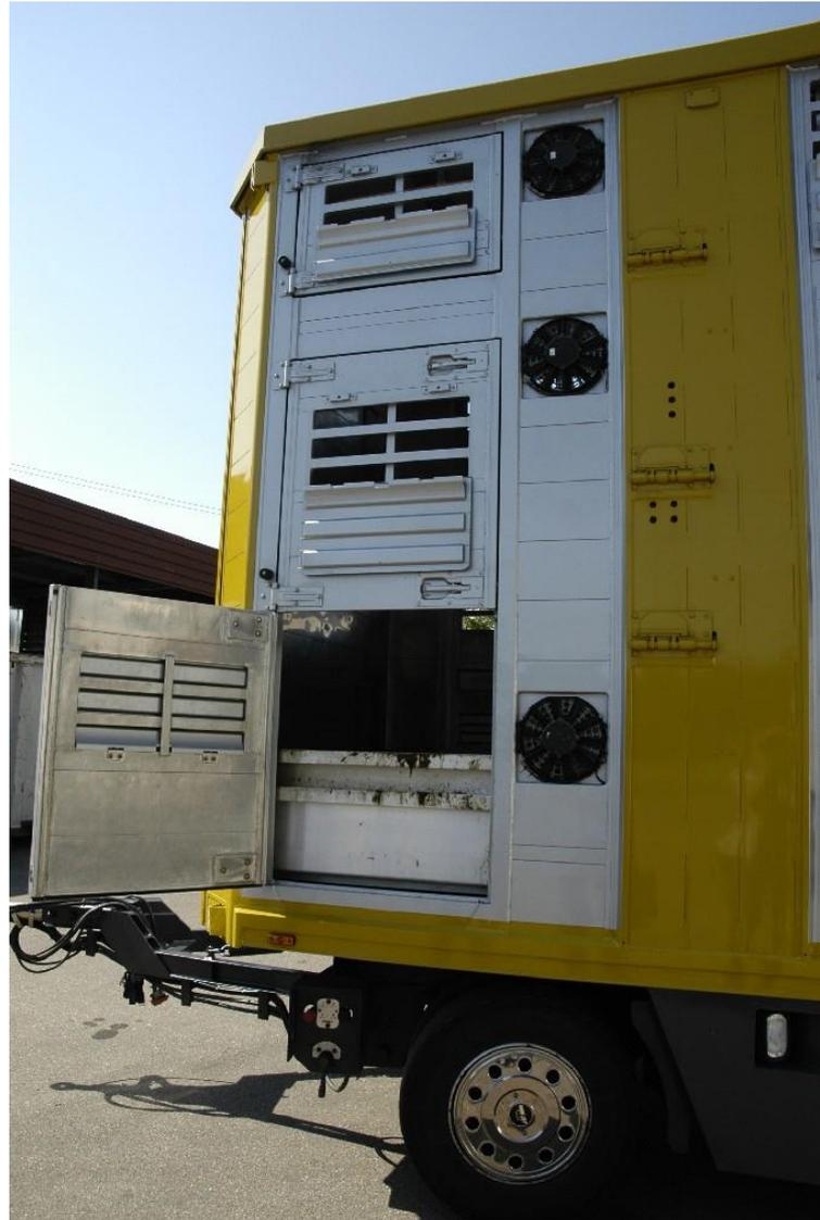
Durch geteilte Türen kann jede Etage separat geöffnet werden. Bei durchgehender Tür müsste ein zusätzlicher Schutz vor Herausstürzen der Tiere vorhanden sein.
