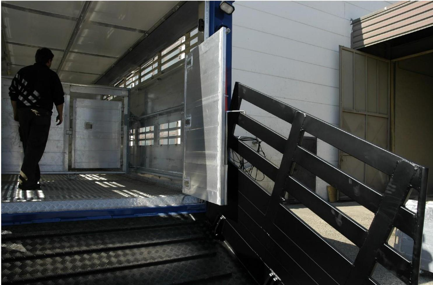
Zwischen der Fahrzeugrückwand und dem Seitenschutz der Laderampe darf kein Spalt offen bleiben. Hier wird der Spalt beidseits durch die geteilte hinterste Trennwand verschlossen.
