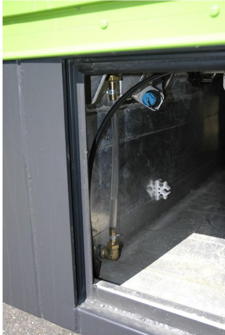
Der als Wasserstandsmesser verwendete durchsichtige Schlauch muss mit einer Skala versehen werden, um ein sinnvolles Ablesen des Wasserstandes zu ermöglichen.
