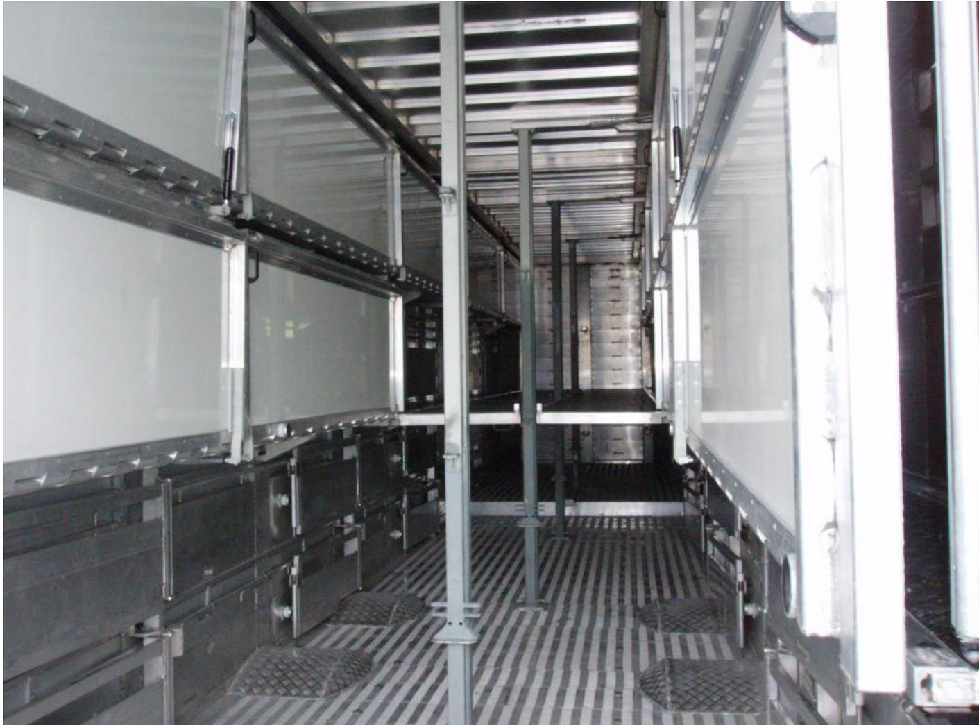
Klappböden: die Trennwände sind konstruktionsbedingt nicht verschieblich
