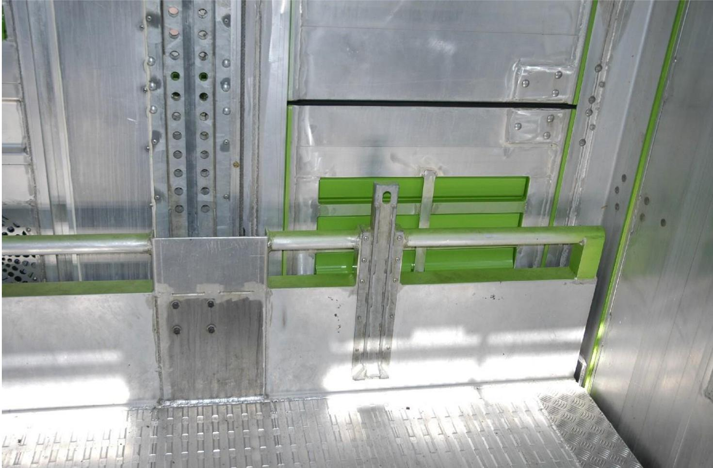
Zwischen Hubböden und Fahrzeugwand besteht die Gefahr des Einklemmens von Gliedmaßen. Hohe Ränder an den Hubböden, wie hier, sind ein guter Schutz.
